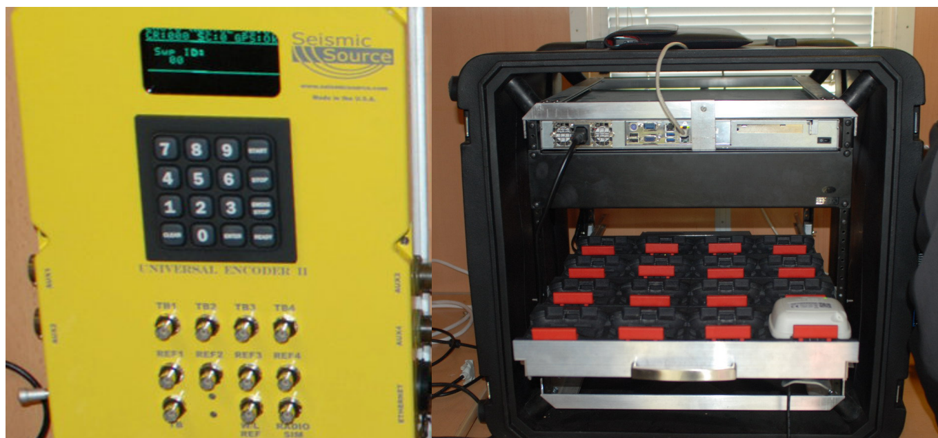
Universal Encoder II, zastępujący w systemie Innoseis VibPro oraz stacja, w której czytujemy dane i ładujemy baterie nodów
