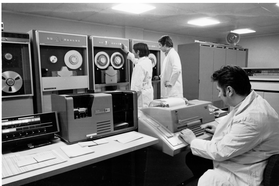
Minikomputer EMR 6135. W prawym rogu szafy z pamięcią ferrytową o pojemności 32 KB
