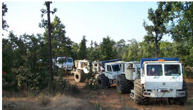
E-38: Wibratory w rejonie prac
