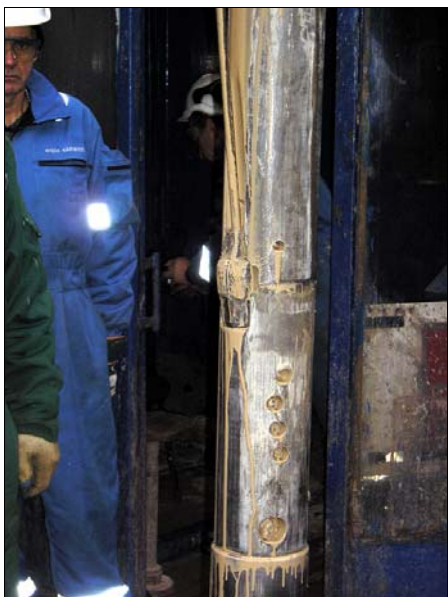
Okno w przewodzie wiertniczym (Side Entry Sub) do zapuszczania kabla karotażowego z wet connectorem
