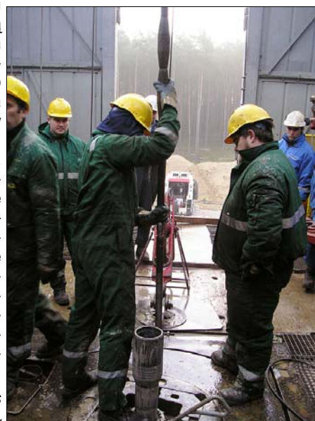
Obciążnik z górną częścią konektora (sinker bar with female wet connector)
