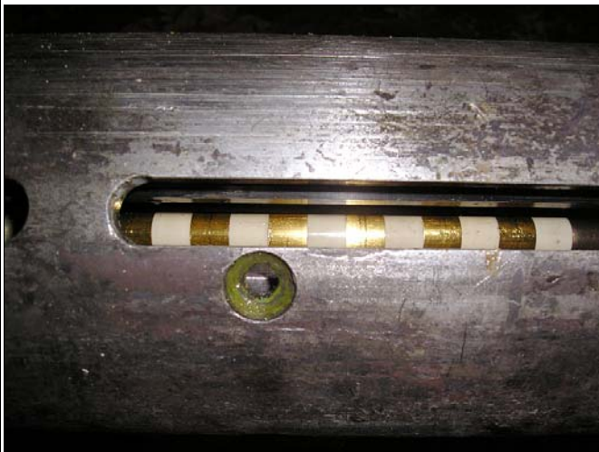
Dolna część konektora do łączenia na mokro w płucce (male wet connector)
