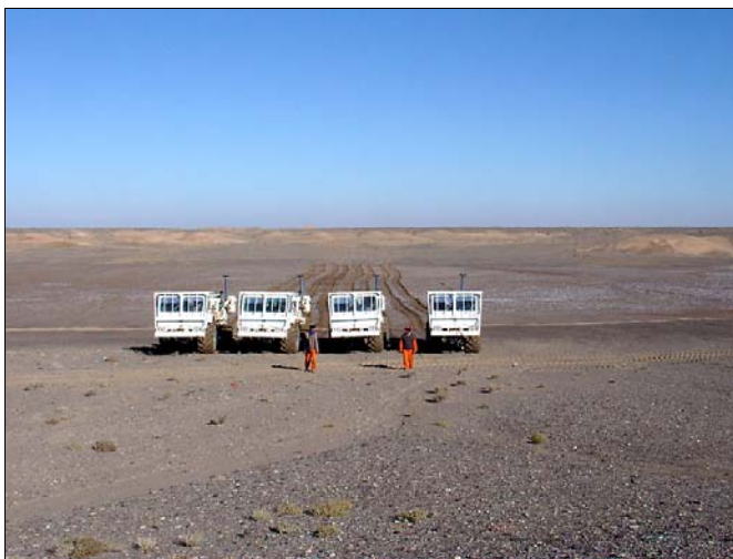
Wibratory przejeżdżały co 17.5m w odległości 2 m jeden od drugiego, stąd potrzeba wskazywania miejsca wibrowania przez idącego pracownika
